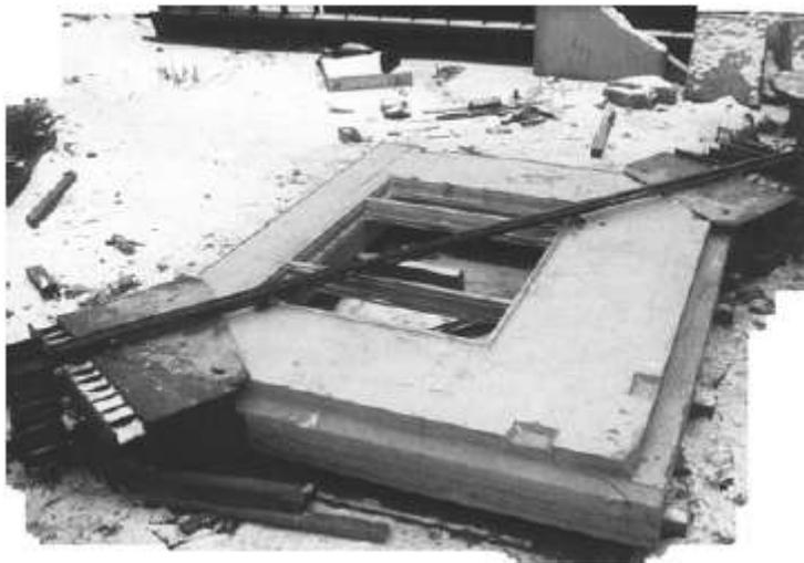
Рис.3. Схема прочностных испытаний трехслойной стеновой панели на дискретных связях
